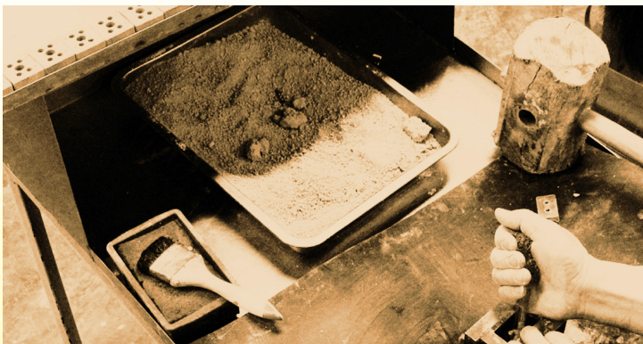
Blocchi terminali in porcellana realizzati a mano mediante pressatura a martello: Riempimento manuale del granulato umido (Collezione privata) Essiccazione della porcellana elettrica dopo la pressatura (Collezione privata)
